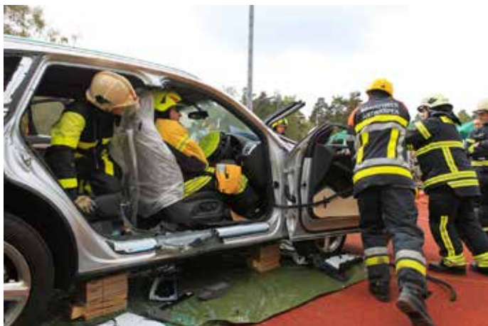
Bild 1: Große Seitenöffnung – Schnelle Möglichkeit, um mit wenig Aufwand viel Platz für eine achsengerechte Rettung durch die Fahrzeugseite zu schaffen.
