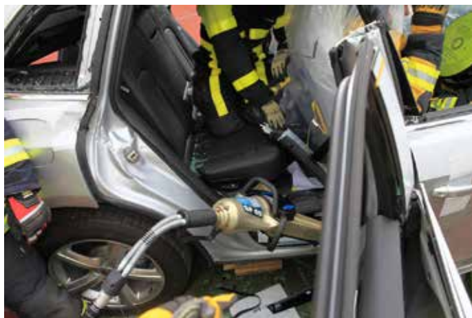
Bild 3: Eine Möglichkeit, um die B-Säule mit dem Spreizer auszureißen.
